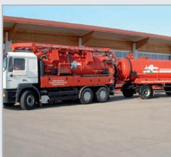
Sämtliche Transporte, und Reinigungen und Entleerungen werden ausschließlich mit qualifiziertem Personal durchgeführt. Die Einsatzfahrzeuge sind mit einer Hochdruckanlage zum Reinigen der Anlagen oder zur Rohrreinigung ausgestattet.
